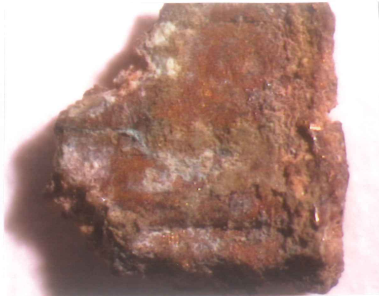
Foto 1. Aspecto que presenta la costra de alteración vista al microscopio binocular.
